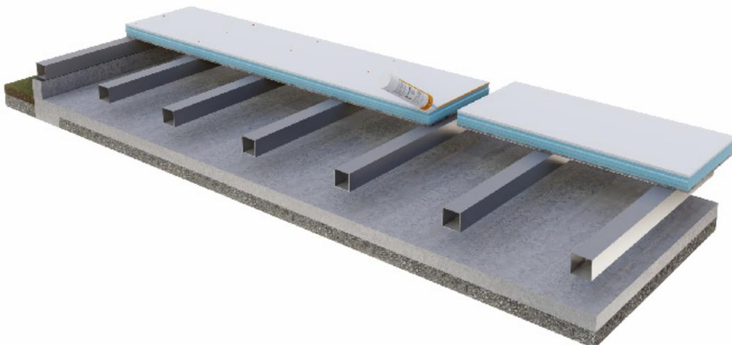
**Paso 3.-** Colocación del siguiente panel y fijación en todos los apoyos menos en el apoyo compartido con el anterior panel.
