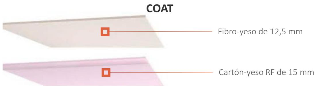
La doble placa COAT se coloca en trasdosados y falsos techos, con el fibro-yeso hacia la estructura y la placa de cartón-yeso al interior.
