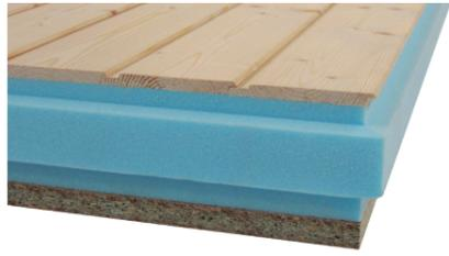
**THERMOCHIP FRISO DE ABETO (TAH)** está formado por un tablero superior de aglomerado hidrófugo de 19 mm, un núcleo aislante de poliestireno extruído y un acabado decorativo en friso de abeto de 10 mm de espesor. Puede suministrarse en acabado natural o lasurado. \*Ver apartado de Lasures.
