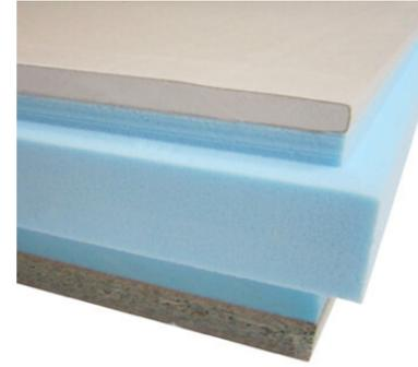
**THERMOCHIP PLACA DE YESO LAMINADO (TPLH)** está formado por un tablero superior de aglomerado hidrófugo 19 mm, un núcleo aislante de poliestireno extruído y un acabado interior de placa de yeso laminado de 13 mm de espesor. Este panel tiene un acabado interior de bordes afinados para una correcta aplicación de la pasta y cinta entre la junta de paneles. Este panel permite cualquier acabado interior que habitualmente se realiza sobre las superficies de placa de yeso laminado.
