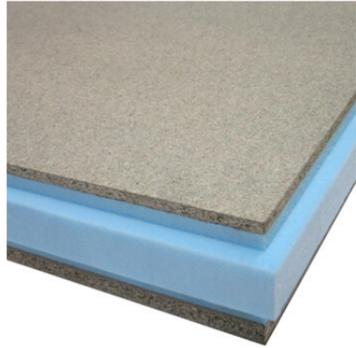
**THERMOCHIP AGLOMERADO (THH)** está formado por un tablero superior de aglomerado hidrófugo de 19 mm, un núcleo aislante de poliestireno extruido y un acabado interior de aglomerado de 10 mm de espesor. El acabado superior en aglomerado nos permite cualquier tipo de revestimiento en cubierta y el tablero interior está listo para pintar incorporar un acabado de papel o cualquier otro tratamiento decorativo.
