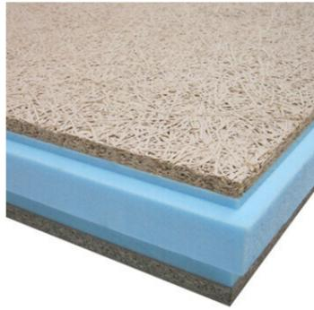
**THERMOCHIP HERAKLITH (TKH)** está formado por un tablero superior de aglomerado hidrófugo de 19 mm, un núcleo aislante de poliestireno extruído y un acabado interior de virutas de madera con magnesita de 15 mm de espesor. Este tipo de panel es el adecuado para espacios con requerimientos de **ABSORCIÓN ACÚSTICA** o para espacios con altos niveles de **HUMEDAD**, además ofrece un buen comportamiento en **REACCIÓN A FUEGO B-s1, d0**.
