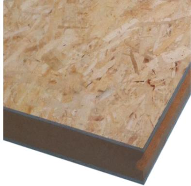
**THERMOCHIP TOO (TOO)** está formado por un tablero superior de fibras orientadas OSB de 15 mm, un núcleo aislante de fibra de madera, una barrera de vapor y un acabado interior de de fibras orientadas OSB de 15 mm.
