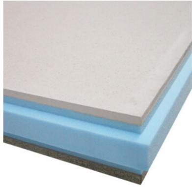
**THERMOCHIP FIBROYESO (TYH)** está formado por un tablero superior de aglomerado hidrófugo de 19 mm, un núcleo aislante de poliestireno extruído y un acabado interior de fibroyeso de 10 o 12 mm de espesor. Su acabado en tablero de alta densidad, le aporta un buen AISLAMIENTO ACÚSTICO, además de ofrecer un adecuado comportamiento en REACCIÓN A FUEGO B-s1, d0.
