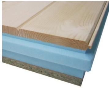
**THERMOCHIP TARIMA DE ABETO (TAH)** está formado por un tablero superior de aglomerado hidrófugo de 19 mm, un núcleo aislante de poliestireno extruído y un acabado decorativo en tarima de abeto de 19 mm de espesor. Puede suministrarse en acabado natural o lasurado. \*Ver apartado de Lasures.
