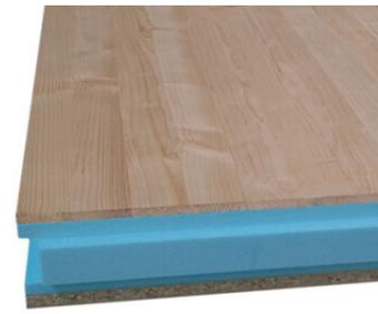
**THERMOCHIP ALISTONADO DE ABETO (TAH LT)** está formado por un tablero superior de aglomerado hidrófugo de 19 mm, un núcleo aislante de poliestireno extruído y un acabado decorativo en alistonado de abeto de 10 mm de espesor. Puede suministrarse con o sin ranuras, y en acabado natural o lasurado. \*Ver apartado de Lasures.
