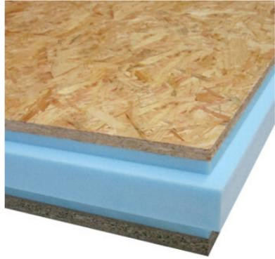
**THERMOCHIP OSB (TOH)** está formado por un tablero superior de aglomerado hidrófugo de 19 mm, un núcleo aislante de poliestireno extruído y un acabado interior de fibras orientadas OSB 10 o 15 mm de espesor. Los tableros utilizados son OSB3 con tres capas orientadas de virutas de madera. Son tableros para medios húmedos con posibilidad de su uso en exteriores.
