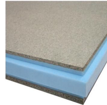
**THERMOCHIP AGLOMERADO GRAN FORMATO (GF THH)** está formado por un tablero superior de aglomerado hidrófugo de 19 mm, un núcleo aislante de poliestireno extruido y un acabado interior de aglomerado de 19 mm de espesor. Este panel tiene un formato especial de cinco metros de longitud, lo que permite salvar luces de hasta 2,50 m, disponiendo el panel siempre sobre tres apoyos.
