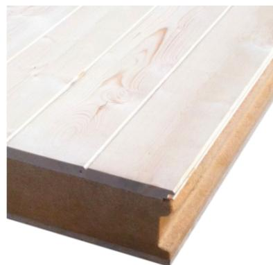
**THERMOCHIP TAO WF (TAO WF)** está formado por un tablero superior de fibras orientadas OSB de 15 mm, un núcleo aislante de fibra de madera, una barrera de vapor y un acabado interior de tarima de abeto de 19 mm de espesor. Puede suministrarse en acabado natural o lasurado. \*Ver apartado de Lasures. Los tableros utilizados son OSB3.
