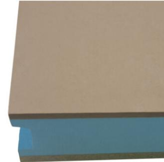
**THERMOCHIP FIBROCEMENTO (TFbcH)** está formado por un tablero superior de aglomerado hidrófugo de 19 mm, un núcleo aislante de poliestireno extruído y un acabado decorativo en fibrocemento de 10 mm de espesor. Es un panel de altas prestaciones acústicas e ignífugas con una **REACCIÓN A FUEGO** B-s1, d0 gracias a contar con un acabado en tablero de alta densidad, formado por una mezcla homogénea de cemento y fibras.
