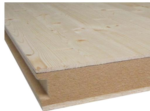
**THERMOCHIP TAO LT WF (TAO LT WF)** está formado por un tablero superior de fibras orientadas OSB de 15 mm, un núcleo aislante de fibra de madera, una barrera de vapor y un acabado interior de alistonado de abeto de 10 mm de espesor. Puede suministrarse con o sin ranuras, y en acabado natural o lasurado. \*Ver apartado de Lasures.
